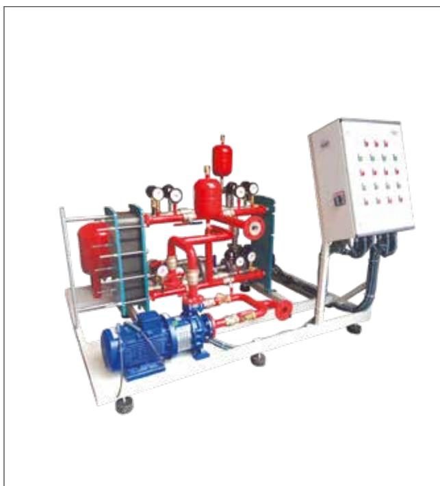
Система охлаждения индукционной печи с двойным теплообменником.
