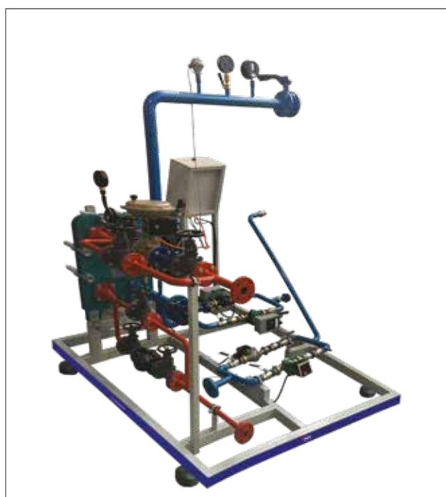
Спроектированный для химической фабрики паровая система подготовки горячей воды.
