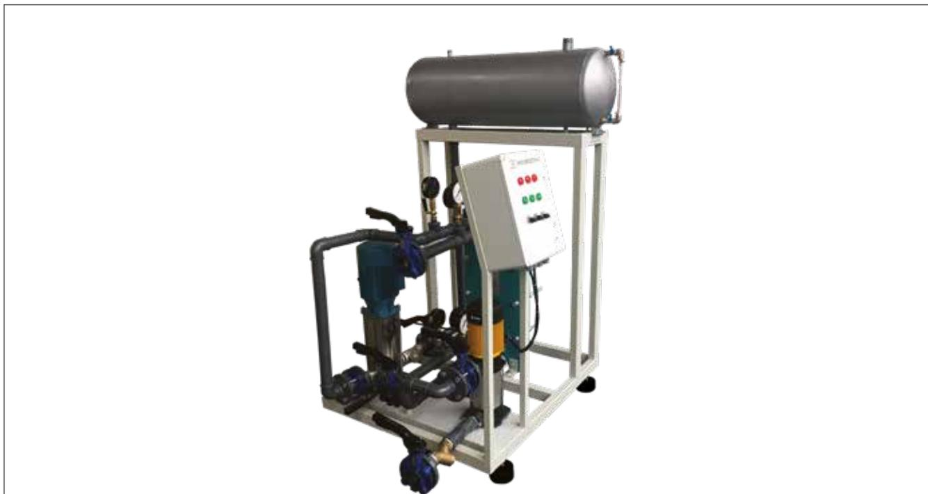
Система охлаждения индукционной печи.
