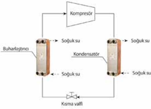
Sulu Soğutma Devreleri
