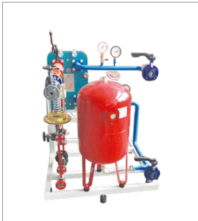
Система для нагрева серпантина резервуара с использованием тепла пара.
